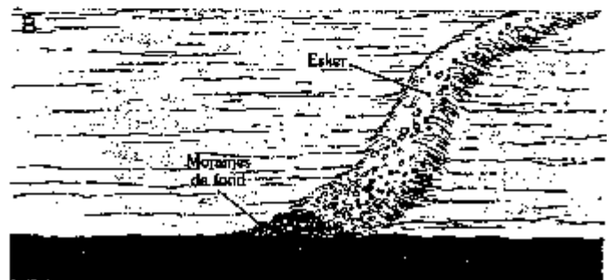
Figure 4.94 Formation d'un esker. En A, un cours d'eau s'est formé sous le glacier et y abandonne des moraines. En B, quand le glacier a fondu, les débris forment un bourrelet, c'est-à-dire un esker.
